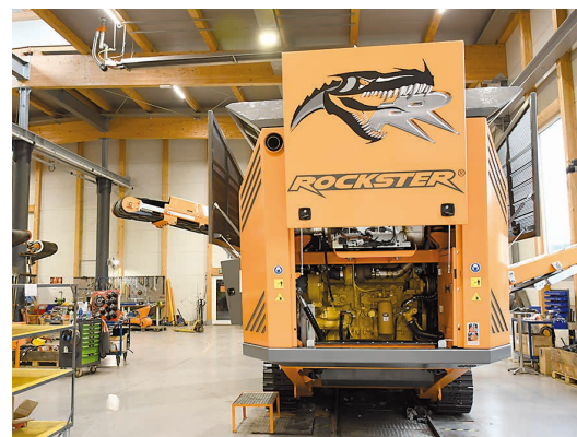
Einblick in die Fertigung. Bis zu drei Brecher gleichzeitig können die Endmontage durchlaufen. Hinter der großen Heckklappe des R1000S steckt der Stufe-V Cat-Motor.
