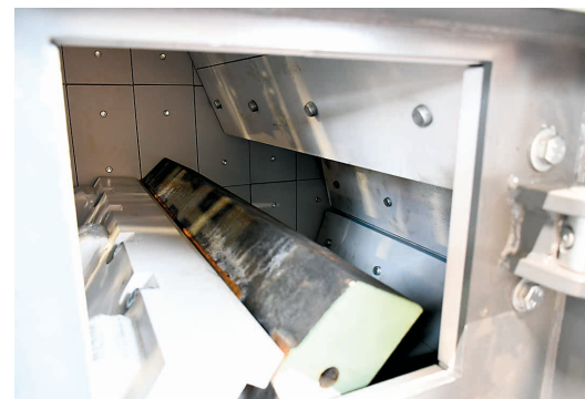
Im dick gepanzerten Hardox-Käfig entfesselt der ca. 3 Tonnen schwere Rotor des R1000S Urgewalten. Der Brechspalt lässt sich stufenlos einstellen.
